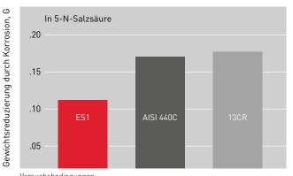
Versuchsbedingungen: Versuchskörper: Ø 18 × 10 mm / Versuchslösung: 300 ml Eintauchdauer: 20 Stunden (bei Raumtemperatur)
