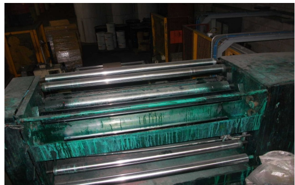
↑ Rollen einer Färbemaschine für Papier
