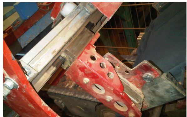
↑ Führungswagen vor dem Einbau der NSK K1-Einheit
