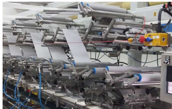
↑ Schneide- und Stapellinie für Feuchttücher
