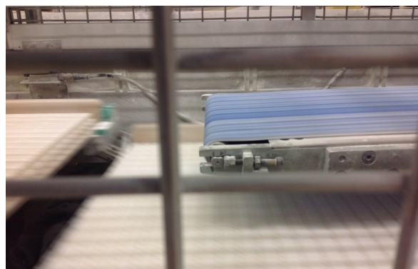
↑ Końcowy krążnik w przenośniku zbiornika zanurzeniowego
