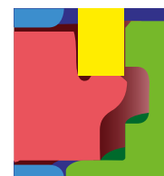
Protrusione ottenuta per punzonatura della piastra (in 3 punti)
