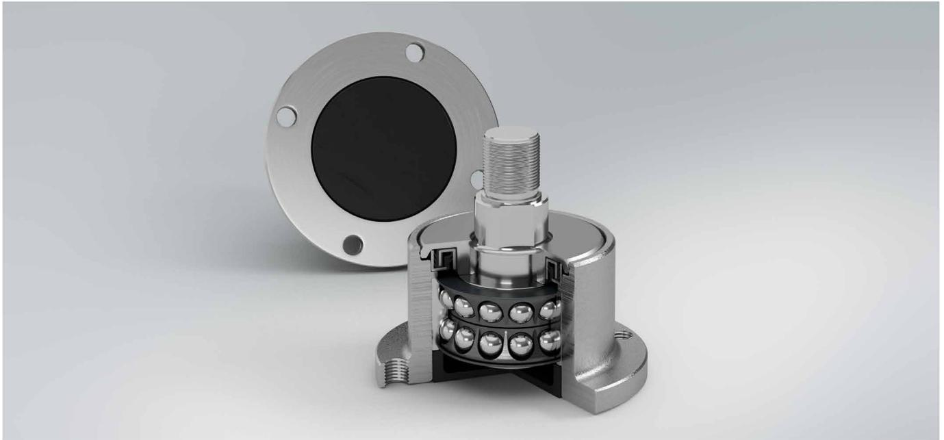
El Hub de NSK con brida (4,5,6 agujeros para atornillar), sellado, eje integrado y rodamiento de bolas de contacto angular de 40°. Especialmente diseñado para ser intercambiable, sin mantenimiento, incrementa la fiabilidad y disponibilidad en condiciones extremas. Para aplicaciones como compactadores, siembra, segado y limpieza de maleza.
