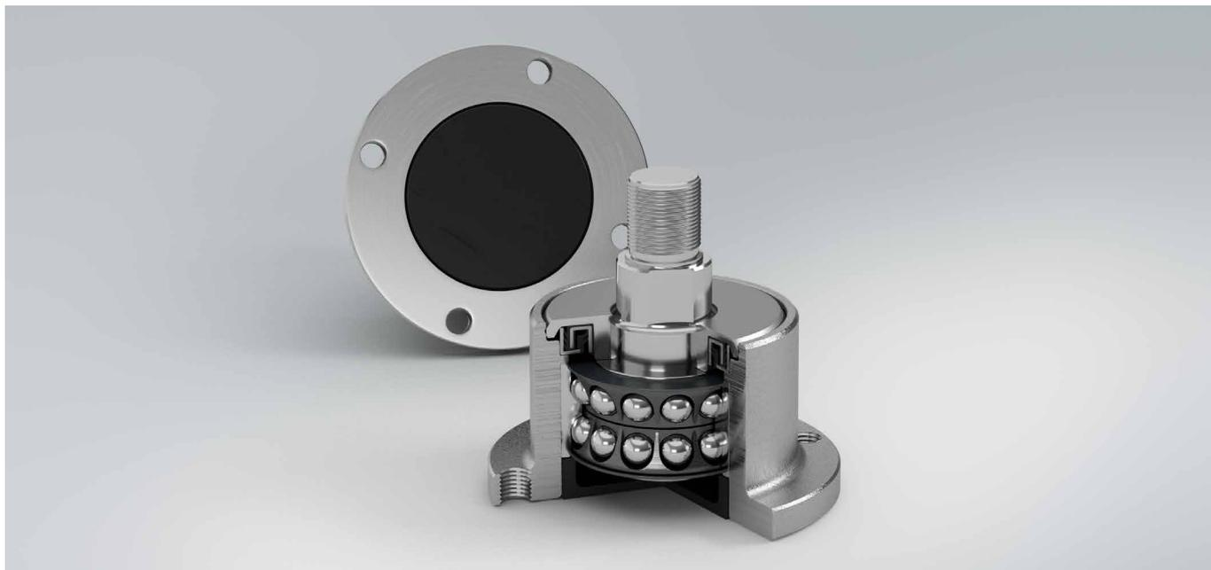
Moyeu Agri Disc Hub NSK (4, 5, 6 trous) avec étanchéité par joint cassette et roulements doubles rangées avec un angle de contact de 40°. Interchangeable et sans entretien de par sa conception spéciale, il augmente la disponibilité et la fiabilité des machines dans des conditions extrêmes. Adapté pour les déchaumeurs, les rouleaux frontaux, les disques semoirs, les bineuses à doigt et le désherbage mécanique.
