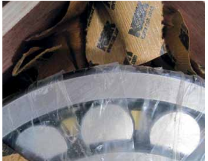
B. Rodamiento falsificado
