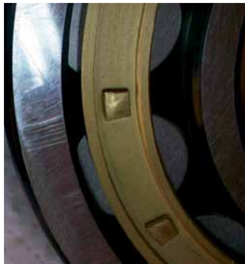
B. Rodamiento falsificado
