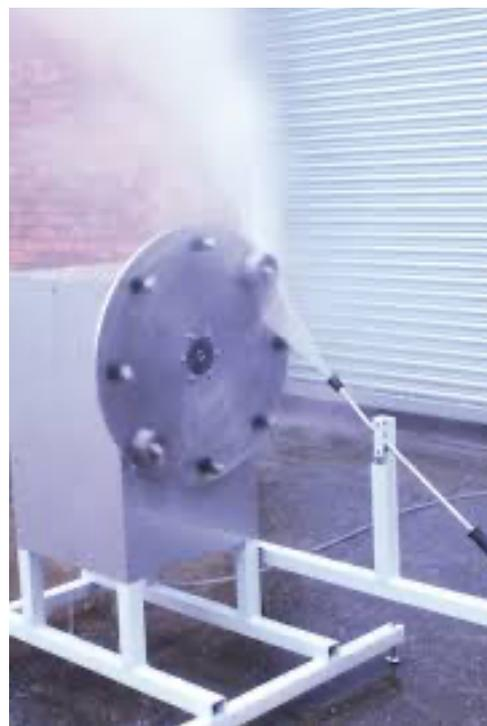
Banco di prova per lavaggio a pressione 110 bar
