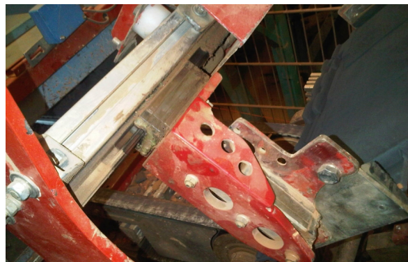
↑ Patín con sistema de lubricación sólida K1
