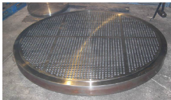
↑ Piastra dello Scambiatore di Calore
